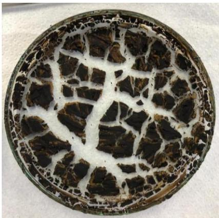
Figura 1 GO después de 20 h en deshidratación a 40 °C.
